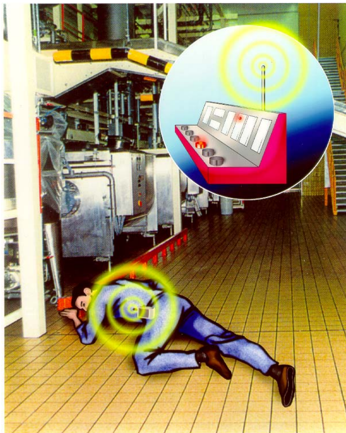
Bild 1: Schema einer Personen-Notsignal-Anlage
